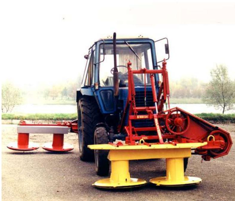
Предназначена для скашивания травы и укладки в прокос между колесами трактора. Агрегируется с тракторами МТЗ-80/82. Навешивается спереди трактора. Привод от бокового ВОМ.
