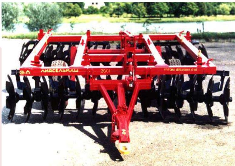
Предназначена для лушения стерни и предпосевной обработки почвы, разработки пластов первичной вспашки, поднятых кустарниково-болотными плугами, на минеральных и торфяных почвах, ухода за лугами и пастбищами, а также разделки глыб после вспашки.
