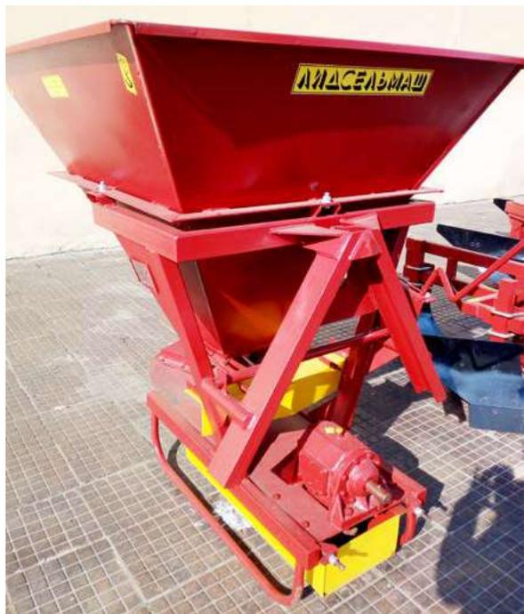
Предназначен для разбрасывания песка и песчано-солевых смесей по тротуарам и дорогам в осенне-зимнее время. Он представляет собой надежную, удобную в обслуживании и несложную по конструкции машину. Она необходима на каждом предприятии, занимающемся обслуживанием тротуаров и дорог в городах и поселках.
