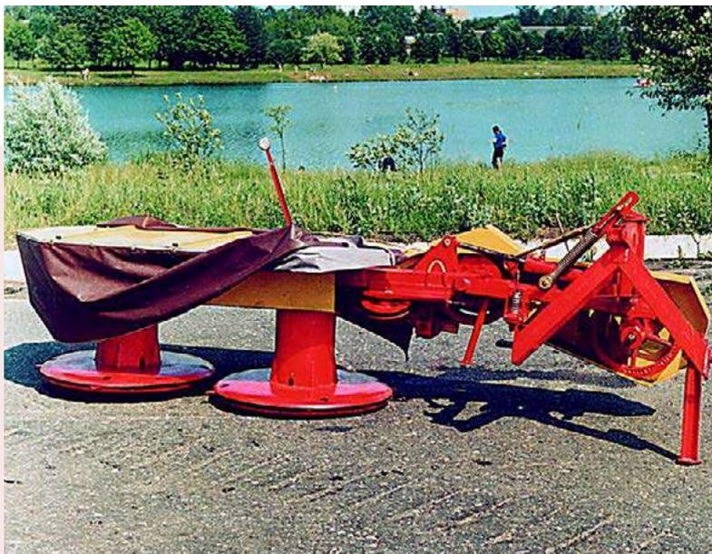
Предназначена для скашивания травы и укладки её в прокос. Скашивание происходит за счет вращения двух роторов с ножами. При случайном наезде на препятствие косилка снабжена демпфирующим устройством.
