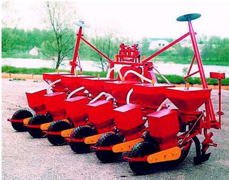
Предназначена для посева пропашных культур: кукурузы, подсолнечника, дражированной свеклы с одновременным внесением минеральных удобрений.
