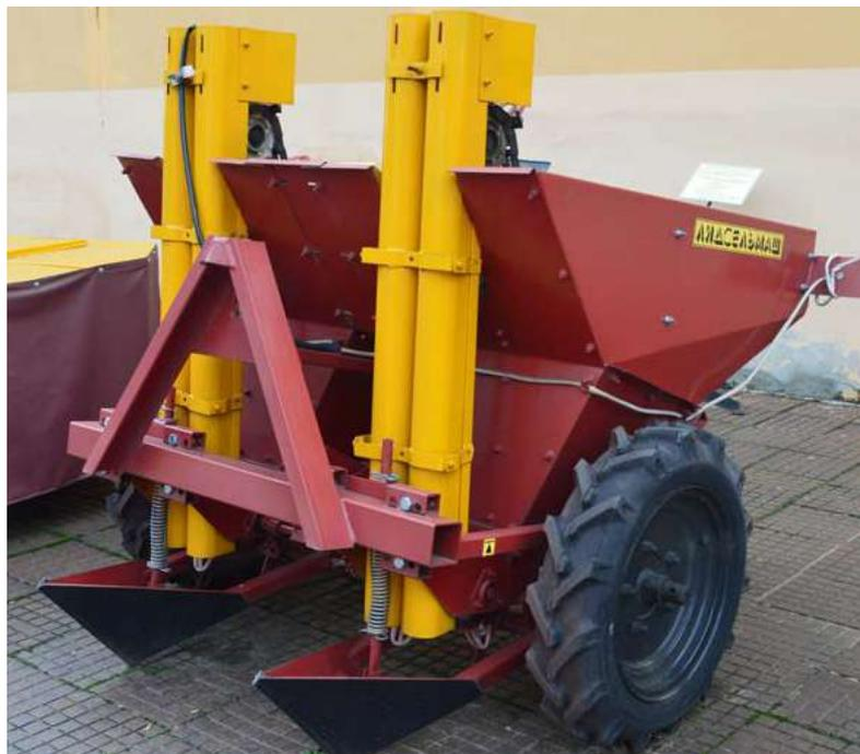
Предназначена для рядковой посадки непророщенных клубней картофеля на мелкоконтурных участках. Картофелесажалка состоит из следующих основных узлов: рама, опорно-приводных колес, высаживающих аппаратов, сошников, бороздозакрывателей, загрузочного бункера, редуктора изменения густоты посадки. Картофелесажалка проста и удобна при обслуживании и регулировках.
