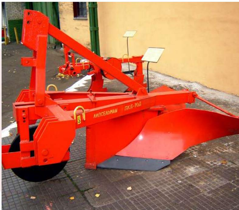
Предназначен для подготовки почвы в виде борозд под посадку лесных культур на не покрытых лесом землях различной степени задернения или на раскорчеванных вырубках, очищенных от порубочных остатков и обеспечивающих проходимость машинно-тракторного агрегата, а также по расчищенным полосам шириной 3,5...4 м. Плуг также предназначен для проведения противопожарных минерализованных полос.
