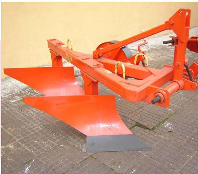
Предназначен для вспашки различных почв с удельным сопротивлением до  $0.9 \text{ кг/см}^2$ , не засоренными камнями во всех климатических зонах. Агрегатируется с тракторами тягового класса 0.6; 0.9.
