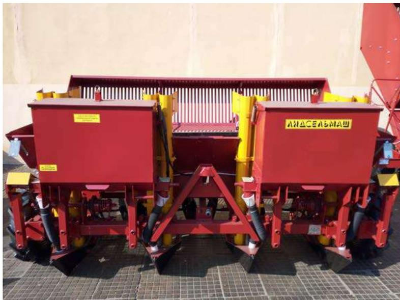
Предназначена для рядковой посадки непророщенных клубней картофеля. Картофелесажалка состоит из следующих основных узлов: рамы, опорно-приводных колес, высаживающих аппаратов, сошников, бороздозакрывателей, загрузочного бункера, редуктора изменения густоты посадки. Оборудована туковысевающими аппаратами для минеральных удобрений.
