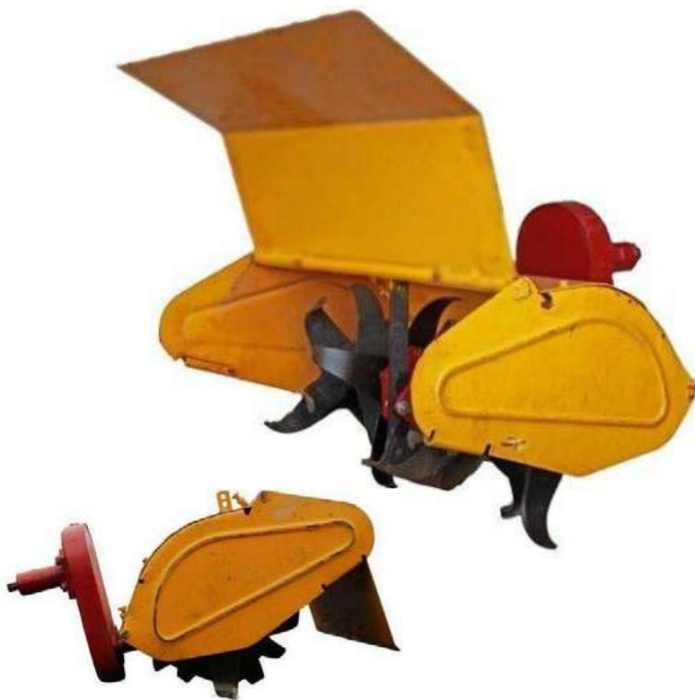
Фреза почвенная ФНМ-1 предназначена для обработки почвы в садах и огородах коллективного и индивидуального пользования.
