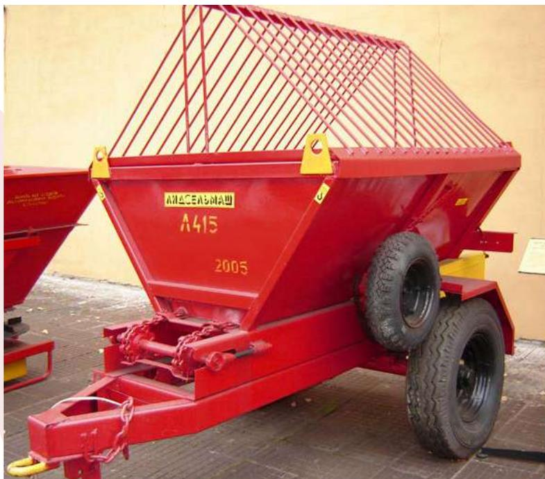
Предназначен для разбрасывания песка и песчано-солевых смесей по тротуарам и дорогам в осенне-зимнее время. Он представляет собой надежную, удобную в обслуживании и несложную по конструкции машину. Она необходима на каждом предприятии, занимающемся обслуживанием тротуаров и дорог в городах и поселках. Дорожный просвет и диаметр колес позволяет маневрировать по тротуарам и дорогам.
