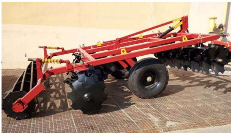
Предназначена для лушения стерни и предпосевной обработки почвы, разработки пластов первичной вспашки, поднятых кустарниково-болотными плугами, на минеральных и торфяных почвах, ухода за лугами и пастбищами, а также разделки глыб после вспашки.
