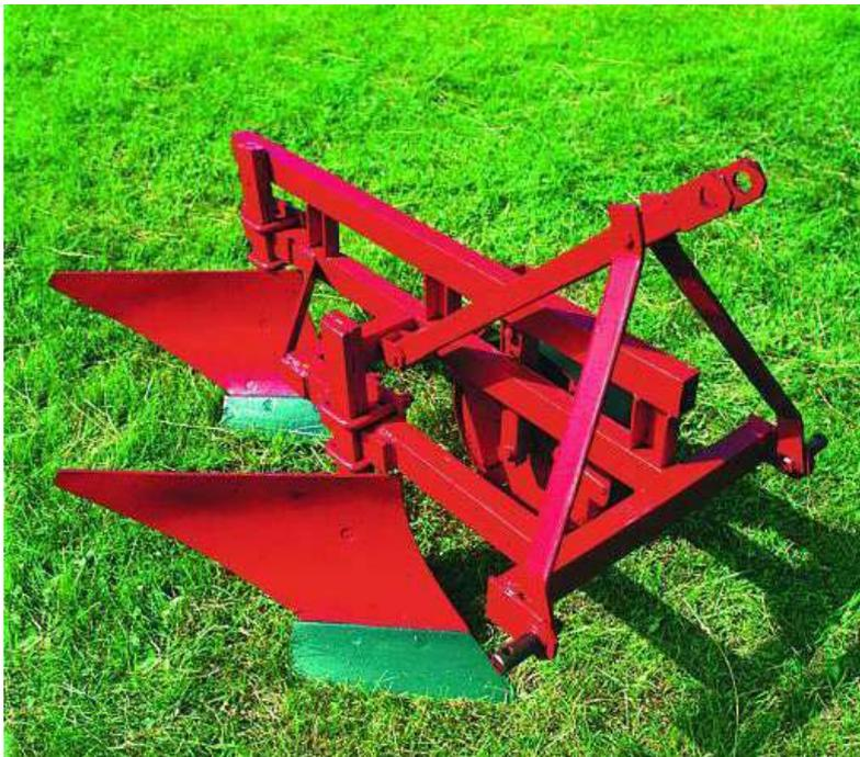
Предназначен для пахоты легких и средних по механическому составу старопашотных почв с удельным тяговым сопротивлением до 0,5 кг/см<sup>2</sup> на приусадебных участках и наделах. Используется во всех почвенно-климатических зонах. Агрегатируется с тракторами тягового класса 0,6.
