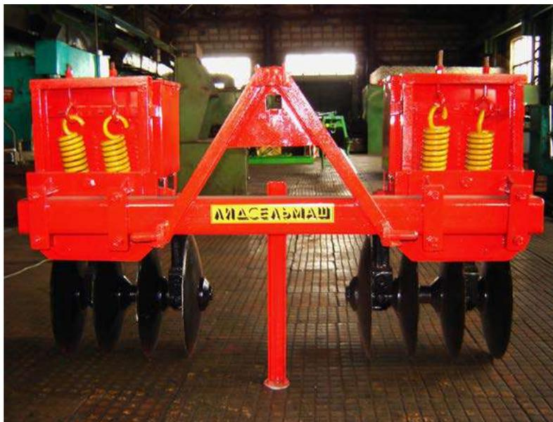
Предназначен для ухода за лесными культурами, посеянными или посаженными по дну борозд, проложенных плугом ПКЛ-70Д, и на полосах, подготовленных лесной фрезой. Агрегатируется с тракторами МТЗ-52, МТЗ-80/82 тягового класса 1,4.
