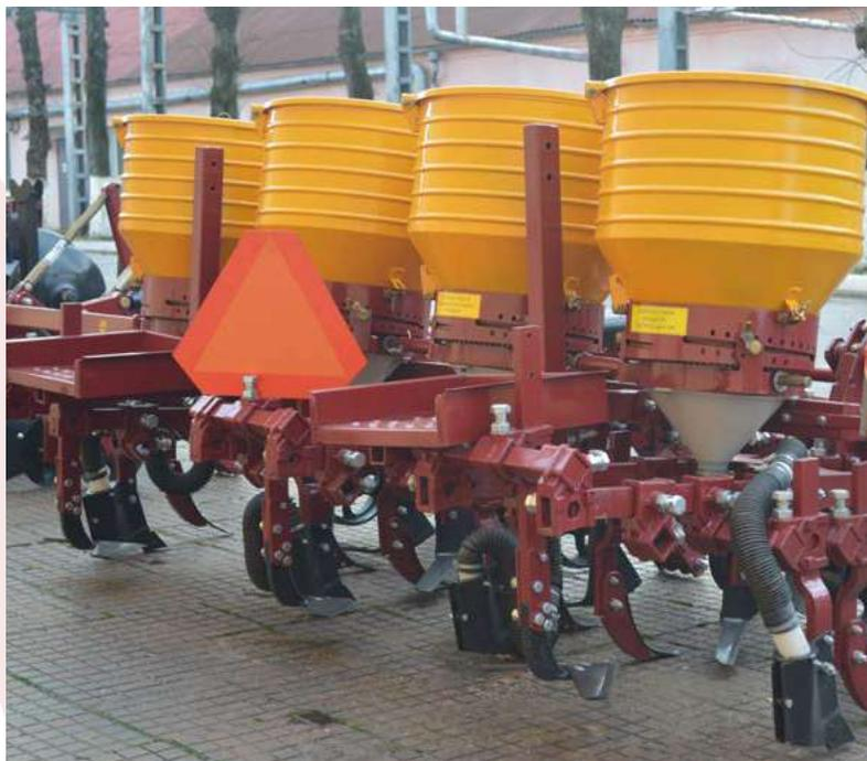
Предназначен для междурядной обработки хлопчатника и других высокостебельных культур в период вегетации, посеянных 4-рядными сеялками.
