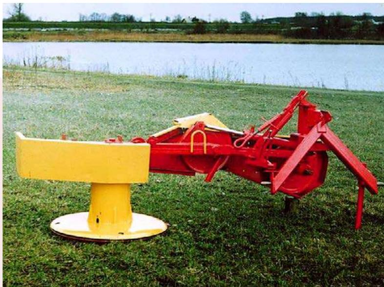
Предназначена для скашивания травы на полях и лугах, очищенных от камней и твердых предметов, и укладки ее в прокос. Агрегатируется с тракторами класса 0,9; 1,4; 0,6.
