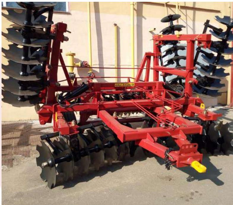
Предназначена для лушения стерни и предпосевной обработки почвы. Борона может использоваться в любых почвенно-климатических зонах.
