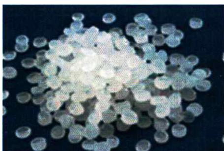
Получают полиэтилен методом радикальной полимеризации этилена в реакторах трубчатого и автоклавного типов при давлении от 1600 до 2100 атм. Выпускается в виде базовых марок и композиций.
